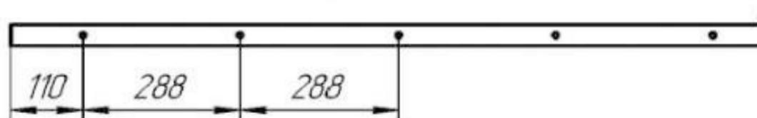
*Схема расположения ступеней относительно элементов каркаса модульной лестницы
